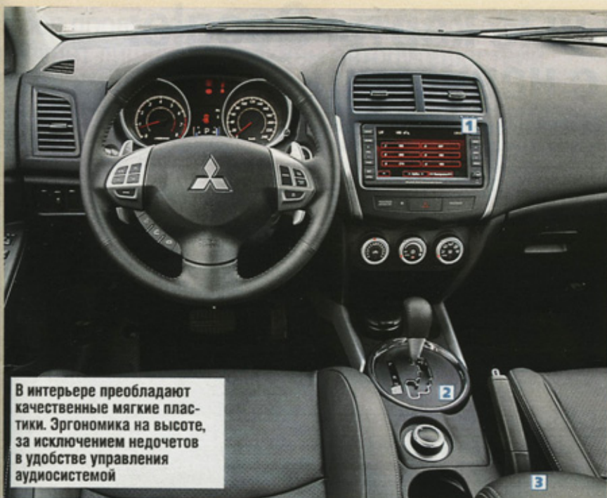
▲ Очень хорошо, что Mitsubishi допускает водителя к выбору режимов полноприводной трансмиссии: 2WD, Auto, 4WD Lock
