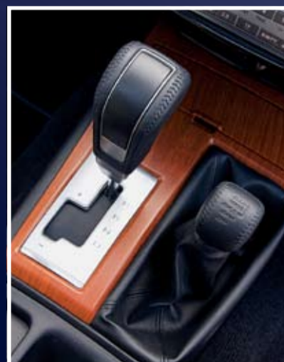
Трансмиссия "Super Select" и принудительная блокировка заднего дифференциала – штатное оборудование.
