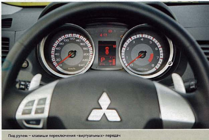
Под рулем — клавиши переключения «виртуальных» передач
