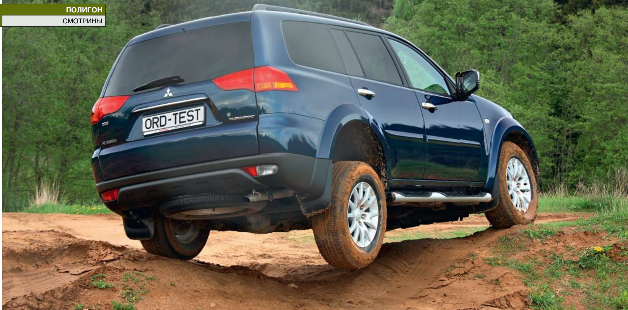
Штатная защита силового агрегата и выглядит внушительно, и от грязи спасает
